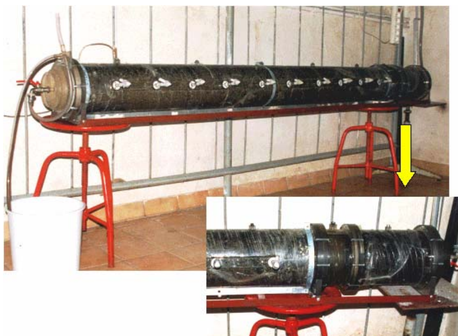
Fot. 1 Reaktor do badań denitryfikacji in situ
